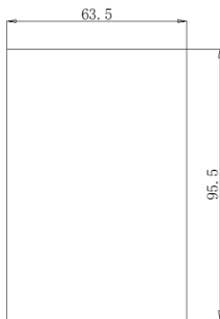
图2-9 外引键盘的安装开孔尺寸
