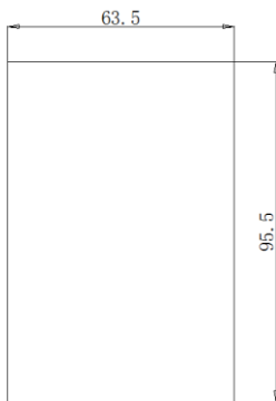
图2-9 外引键盘的安装开孔尺寸
